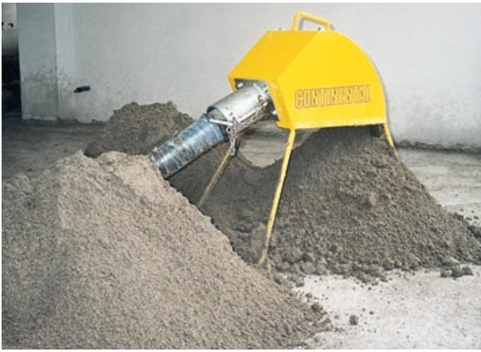
Il sistema é in grado di trasportare numerosi tipi di materiali umidi o asciutti: non strutturali con granulometria fino a 30 mm.
